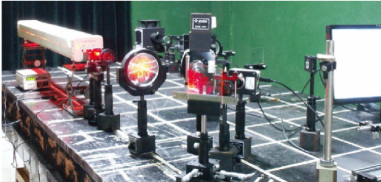
附图 数字激光散斑测量技术光路
